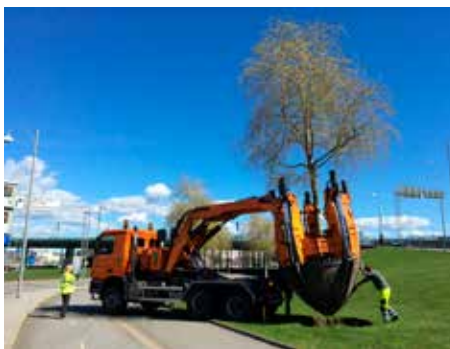
Samma maskin plockar upp, transporterar och sätter ned trädet. Denna transport behövde egentligen mer än ett körfält på vägen.
