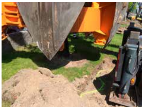
Maskinen kapar rötter på träden som flyttas. Efter återplanteringen ska man gå ner och göra snitt- torna rena och raka.
