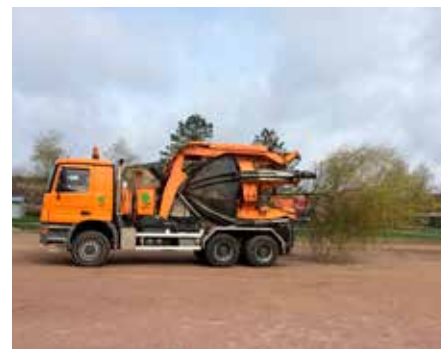
Om kronan, som sticker ut bakom maskinen, skulle vara för yvig för transporten kan den klippas och/eller bindas.
