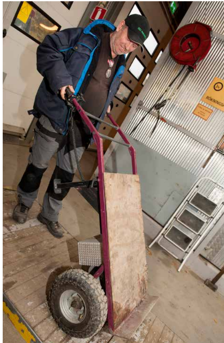
En eldriven Microtruck som förråds- mannen och andra kyrkogårdsarbetare använder för att köra ut små handverktyg och liknande.
