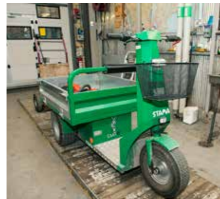
En eldriven Microtruck som förråds- mannen och andra kyrkogårdsarbetare använder för att köra ut små handverktyg och liknande.
