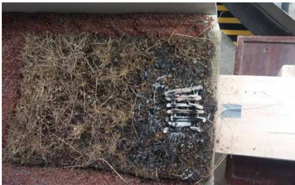
Bild från brandprov. I bilden syns den nyttjade (utbrunna) tändkällan och det brandskadade området. Provet är semi-uttorkat för att motsvara en riktig torrperiod i svenskt klimat och det syns tydligt att branden inte spridit sig mer än lokalt runt tändkällan innan den brann ut och självslocknade.
